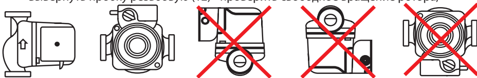
Рис.2. Положение электронасосов при монтаже
