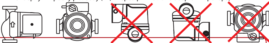
Мал. 2. Положення електронасосів під час монтажу
